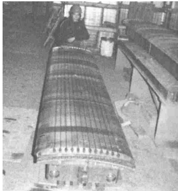
Bild 14.5: Einzelpol eines 250 MVA Generators mit Bohrungen für die Dämpferwicklung
