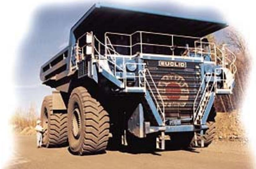
Bild 1.1: Diesel-elektrischer Antrieb eines Muldenkippers in einer Erzmine. An jedem Rad sitzt eine Asynchronmaschine (Siemens)
