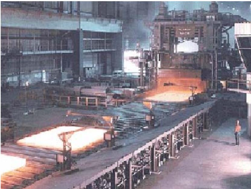
Bild 1.3: Asynchronmaschinen als Förder- und Hauptantrieb in einem Walzwerk.
