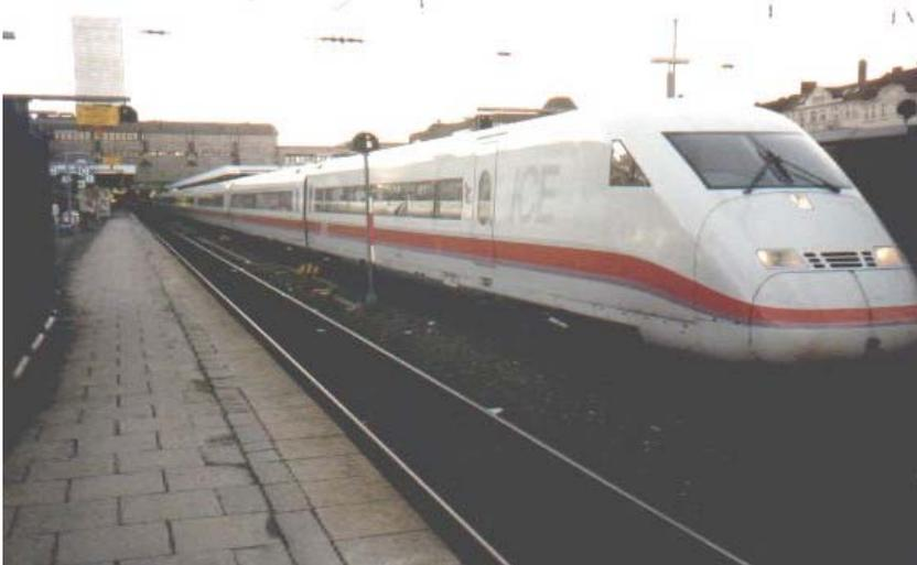
Bild 1.2: Intercity: Asynchronmaschinen als Hauptantrieb. (Hamburg Altona)
