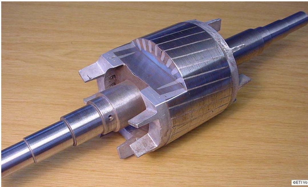
Bild 2.20: Rotor einer Asynchronmaschine mit geschägten Nuten.
