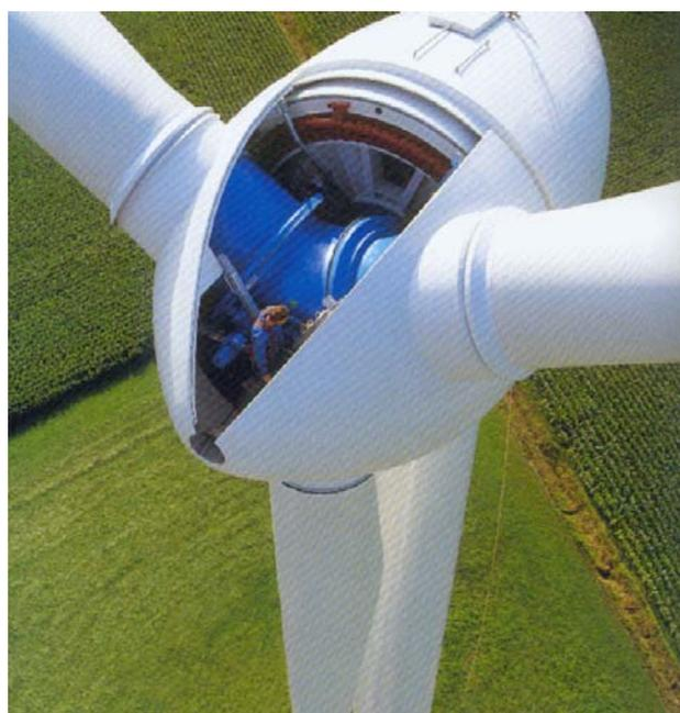
Bild 14.1: Ständer einer Synchronmaschine für Windgenerator (ENERCON)
